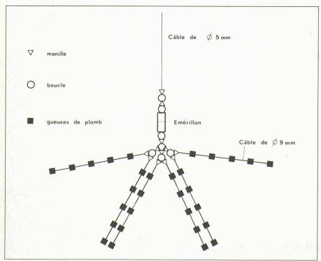
Fig. 5. — Détail de construction: le lest (Allaman-1, 300 Kp).
