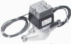
Calorimètre SVME 69 Calorimètre compact, électronique, indépendant du secteur, avec pile longue durée. Elément d'affichage amovible pour montage au mur. Compteur d'eau pour montage horizontal ou vertical. Dimensions très réduites jusqu'aux Ø nom. 15-32 mm.
