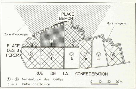
Fig. 1. — Confédération Centre. Principe de découpage et séquences d'exécution des différentes fouilles.
