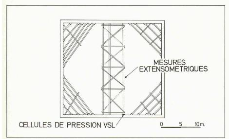
Fig. 3. - Confédération Centre. Fouille 4. Schéma d'étayage et situation des points de mesure.
