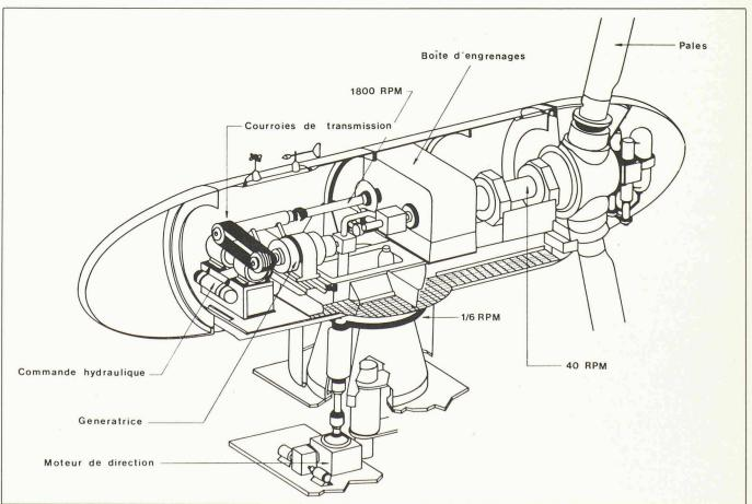
Fig. 1. – Eléments d'une éolienne.
