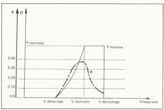
Fig. 3. — Courbe de puissance et du coefficient d'efficacité d'une Mod-2 Nasa.
