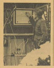
Le dépassement de la concentration limite de CO<sub>2</sub> provoque l'émission d'une alarme avec identification du ou des points de mesure concernés. La structure fonctionnelle de l'équipement de mesure permet son utilisation en liaison avec un ordinateur de
