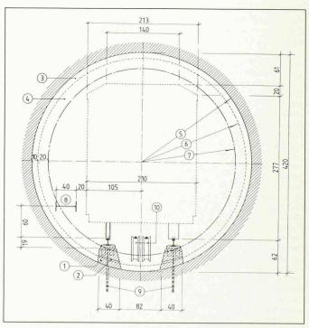
Fig. 1. — Profil normal du tunnel métro-alpin de Felskinn à Mittelallalin au-dessus de Saas Fee: 1. Béton de remplissage Friolite OC — Sikament; 2. Longrine en béton préfabriquée, 5 m de long; 3. Gunite de revêtement selon nécessités; 4. Distance de sécurité aux obstacles; 5. Section totale; 6. Profil éventuellement revêtement; 7. Profil d'espace libre; 8. Escalier métallique; 9. Tirants d'Aliva adhésifs; 10. Galets porteurs du câble.
