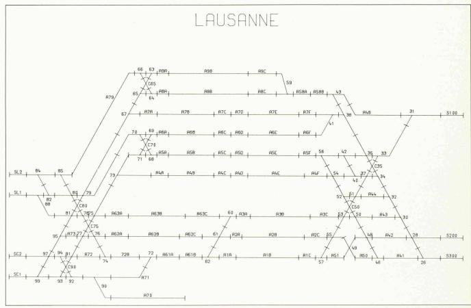
Fig. 2. — Découpage du réseau des voies en éléments d'itinéraire. La numérotation des éléments d'itinéraires du plan schématique est celle qui figure sur les plans des installations de sécurité utilisés par les praticiens. Les traits verticaux délimitant les éléments d'itinéraire correspondent aux joints isolés séparant les circuits de voie.
