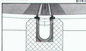
2ème phase: l'élément surélevé est posé sur le caniveau. Maintenant le revêtement définitif peut être mis en place et compacté jusqu'contre le caniveau.
