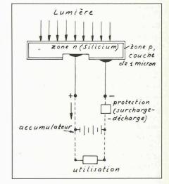
Principe d'une pile solaire au silicium, avec l'accumulateur de stockage et la protection qui empêche la surcharge, ainsi que la décharge du courant en l'absence de lumière.
