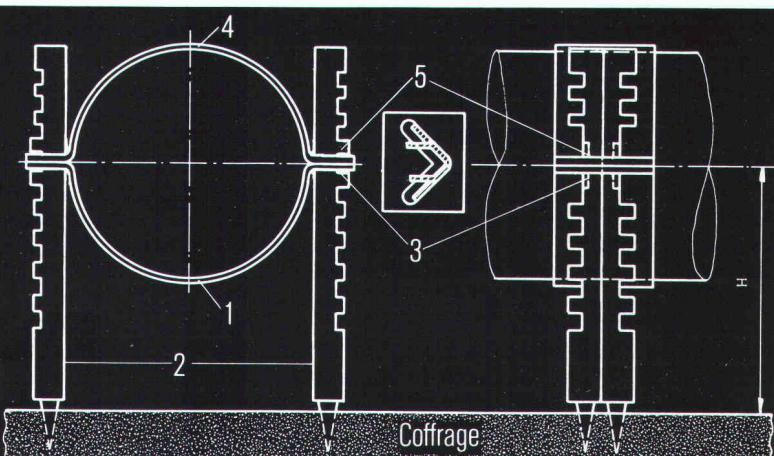
2. Placer le tube dans la partie inférieure (fig. 1), régler la hauteur, courber les cames inférieures (fig. 3) en dedans avec des tenailles.
