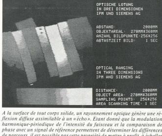
flexion diffuse assimilable à un «écho». Etant donné que la modulation harmonique-périodique de l'intensité du faisceau et la comparaison de phase avec un signal de référence permettent de déterminer les différences de parcours, il est possible par cette propriété de mettre à profit, à échelles spatiales réduites, les méthodes de mesure et de repérage connues du
