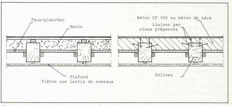
Fig. 4. — Restauration d'un plancher traditionnel.
