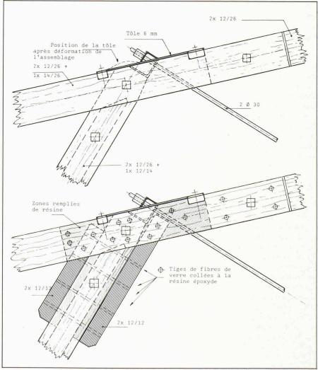
Fig. 2. - Renforcement d'un nœud de charpente.
