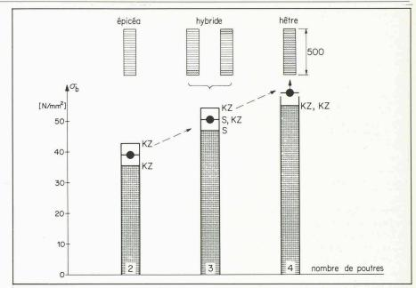
Fig. 9. — Accroissement de la résistance due à l'utilisation de la mes à caractéristiques plus élevées, en particulier pour les zones extérieures tendues. KZ = ruine partant d'un joint à entures multiples; S = rupture par cisaillement (dans l'épicéa).
