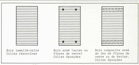
Fig. 3. - Bois lamellé-collé, armé.
