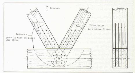
Fig. 6. – Assemblage par broches et goussets métalliques.
