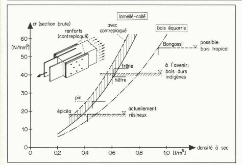
Fig. 5. — Augmentation de la charge supportée par des attaches tendues en fonction de la densité à sec du bois. Toutes les barres ont les mêmes dimensions, avec des contraintes calculées en section brute.
