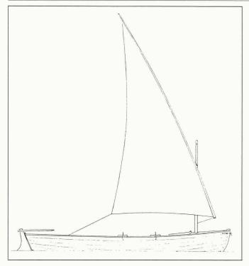
Fig. 4. - Voilure latine du canot dessiné figure 2.
