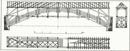
Le pont de Grubenmann à Wettingen est conçu comme une construction moderne en lamellé-collé. Le cintre est formé de poutres superposées et chevillées. La portée est de près de 60 m.
