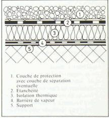
Fig. 1. - Le toit chaud.
