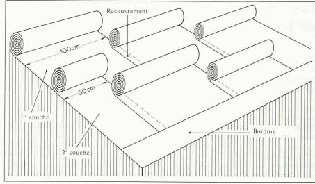
Fig. 2. – Etanchéité bitumineuse multicouche selon [3].
