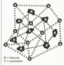
Fig. 2. - Structure du bitume plastomère.
