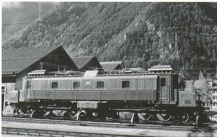
Fig. 5. — Un vétérans au repos devant le dépôt d'Ersfeld en 1981, Ce 6/8 1 14201. Cette locomotive livrée en 1920 est la seule survivante des quatre prototypes livrés en 1919 et 1920 aux CFF. Quelques caractéristiques : masse 99 t, vitesse maximale 65 km/h, puissance unihoraire 1750 kW à 41 km/h. Ce véhicule ne doit sa survie, en 1967 — à une époque où l'on ne s'intéressait pas encore assez à ces témoins pionniers de l'époque de l'électrification —, qu'au fait que la division de la traction et des ateliers avait besoin d'une locomotive pouvant exercer un effort de traction non négligeable pour les trains d'essais des freins. Après avoir circulé en tête de nombreux trains spéciaux quelques années comme locomotive historique habillée en brun, la couleur d'ordonnance des locomotives CFF jusqu'en 1927, la Ce 6/8 1 14201 est entrée en 1982 à la Maison suisse des Transports à Lucerne à l'occasion de l'inauguration de l'agrandissement des halles ferroviaires pour le centenaire de la ligne du Saint-Gothard. (Photo R. Schorno)
