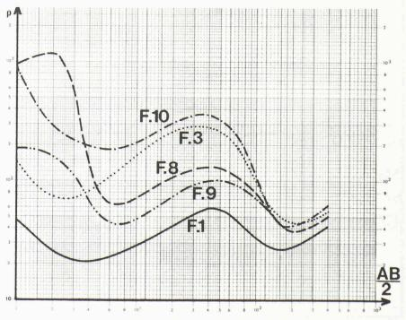
Fig. 2. — Sondages électriques d'étalonnage à l'emplacement des forages.
