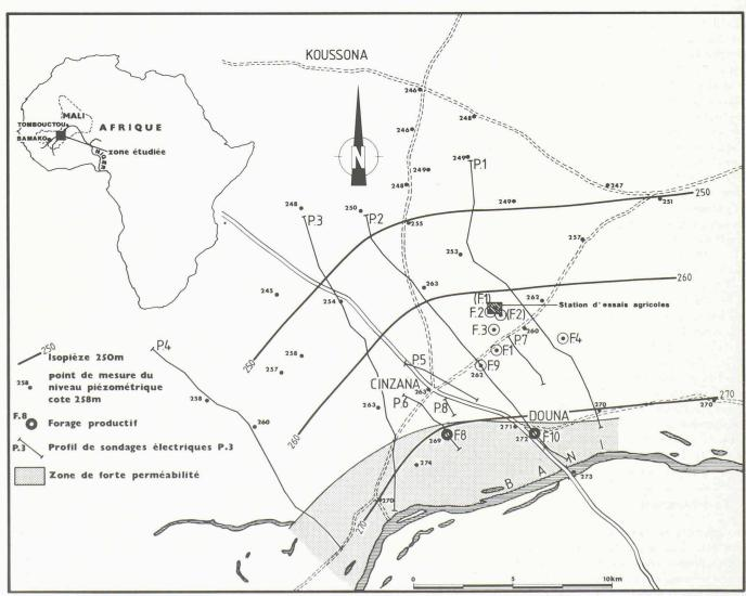
Fig. 1. — Plan de situation et carte piézométrique. Nota : la précision moyenne sur l'altimétrie est de  $\pm$  2 mètres.
