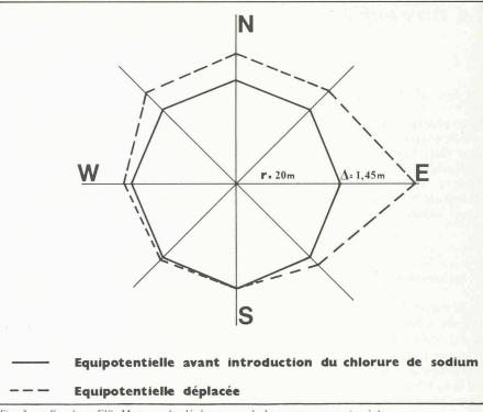
Fig. 3. — Sondage F10. Mesures du déplacement de la nappe par «mise à la masse».
