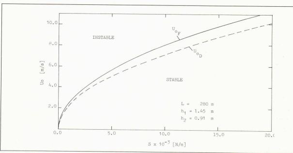
Fig. 4. — Vitesse de divergence,  $U_{0_D}$  et de flottement  $U_{0_F}$  en fonction de la traction S.
