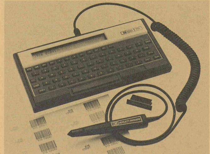
sur piles (HP 82718A) sera disponible en juillet 1984 comme autre option de communications de données. Ce berceau, dans lequel repose le HP-75D, est connecté directement au compartiment batterie de l'ordinateur. Il ajoute au HP-75D deux possibilités : une connexion modem 300 bauds et 32 ou 64 K octets de mémoire disque-électronique. L'ensemble berceau et HP-75D mesure 16,5 × 29,2 × 5,7 cm.
