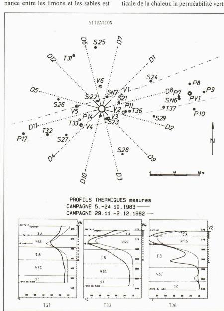
Fig. 5. — Emplacement des drains verticaux destinés à favoriser la pénétration verticale de la chaleur. En bas, trois profils thermiques en phase de charge relevés avant la pose des drains verticaux (ler cycle) et après. L'effet des drains sur la pénétration de la chaleur est remarquable.
