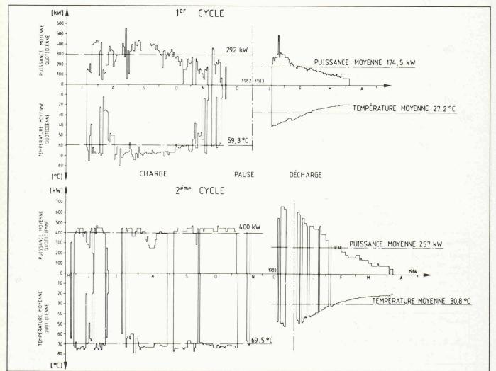
Fig. 6. — Puissance moyenne, énergie injectée et récupérée. Comparaison des valeurs simulées et mesurées. Les rendements mesurés sont nettement supérieurs aux rendements calculés, alors que les températures moyennes de soutirage sont nettement inférieures aux valeurs calculées.
