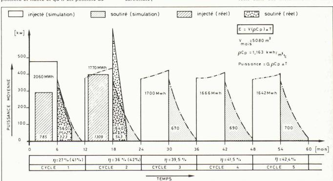
Fig. 8. – Evolution de la puissance moyenne. Energie récupérée et investie.
