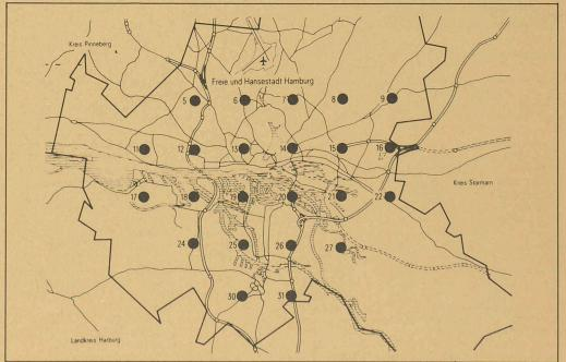
Réseau de mesure automatique de la pollution atmosphérique en cours d'établissement à Hambourg. Dans un premier stade, le réseau partiel comprendra un poste et quatre stations de mesure. Ce réseau partiel a été mis en service début 1984. Le réseau de mesure complet compte 23 stations de mesure automatiques et sera établi fin 1984.
