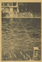
Station hydrométrique moderne du réseau fédéral sur l'Aar à Thoune. Les mesures de vitesse de l'eau peuvent être effectuées depuis la cabine de la station, grâce au téléphérique de jaugeage. On distingue, sur la rive droite, en face de la cabine, le mât auquel est fixé le câble reliant les deux rives.
