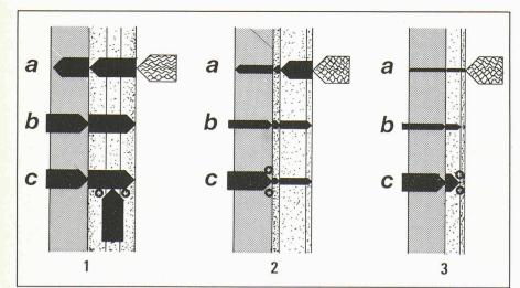
Fig. 1. — Transport d'eau et zones de risque : a) pénétration d'eau de pluie ; b) restitution des quantités d'eau ayant traversé le revêtement ; c) restitution d'eau accumulée dans le support ou le crépi et zones de risques ; I = crépi à la chaux ; 2 = crépi traditionnel ; 3 = enduit à deux couches avec finition synthétique.
