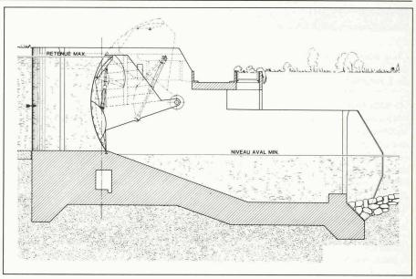
Fig. 4. - Coupe-type d'un barrage avec vanne-segment à clapet.
