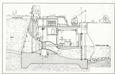
Fig. 5. - Coupe-type d'une usine avec turbine en S.
