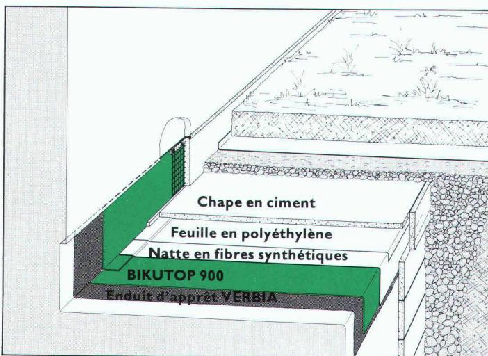
**Le progrès dans la technologie des matériaux permet à Verbia de développer des méthodes nouvelles et rationnelles également pour les étanchéités souterraines. Ici, le revêtement robuste en bitume-élastomère **BIKUTOP® 900** est soudé en monocouche sur le support en béton.**
