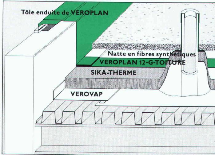
**L'adaptation optimale de l'étanchéité de toiture plate à son support exige de la compétence technique et une gamme complète de produits. Ainsi Verbia a choisi pour cette toiture en tôle profilée **VEROPLAN® 12-G-TOITURE**, la membrane synthétique conforme aux normes et au prix avantageux.**
