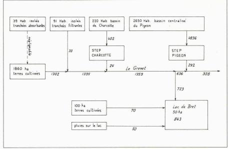
Fig. 3. — Flux annuels de phosphore total pour la variante 4.
