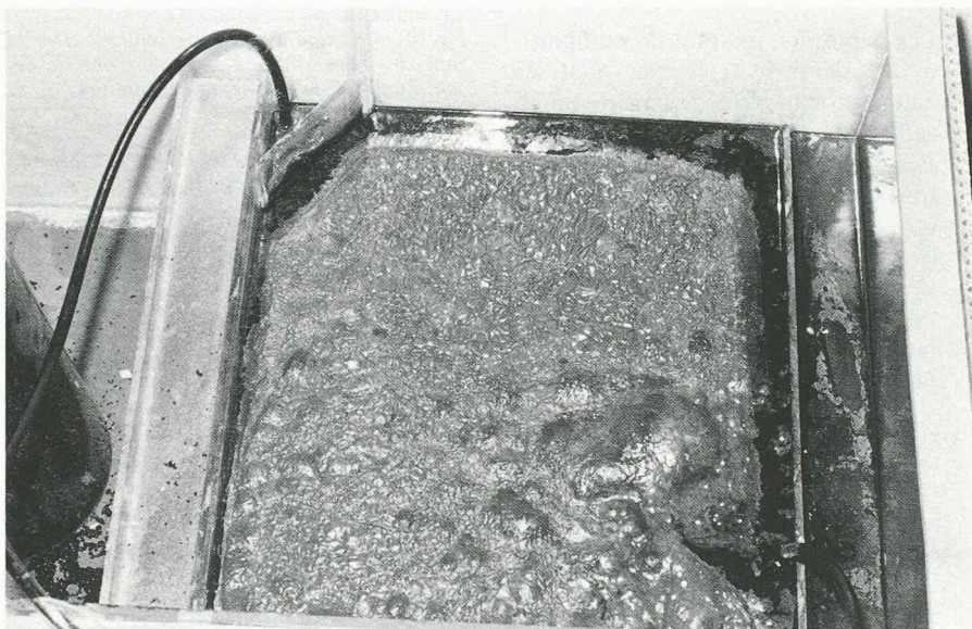
Fig. 6. — Vue d'une fosse à un compartiment réalisée en laboratoire à l'IGE.
