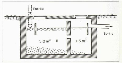
Fig. 2. — Coupe d'une fosse de décantation avec les zones de boues flottantes (A), de décantation avec les zones de boues flottantes (A), de décantation (B) et de digestion (C).
