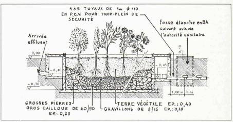
Fig. 3. — Coupe d'un plateau absorbant. Le trop plein éventuel est évacué dans un réseau d'épandage en sous-sol. Tiré de Pratiques de l'assainissement des agglomérations, H. Guerrée, Ed. Evrolles.
