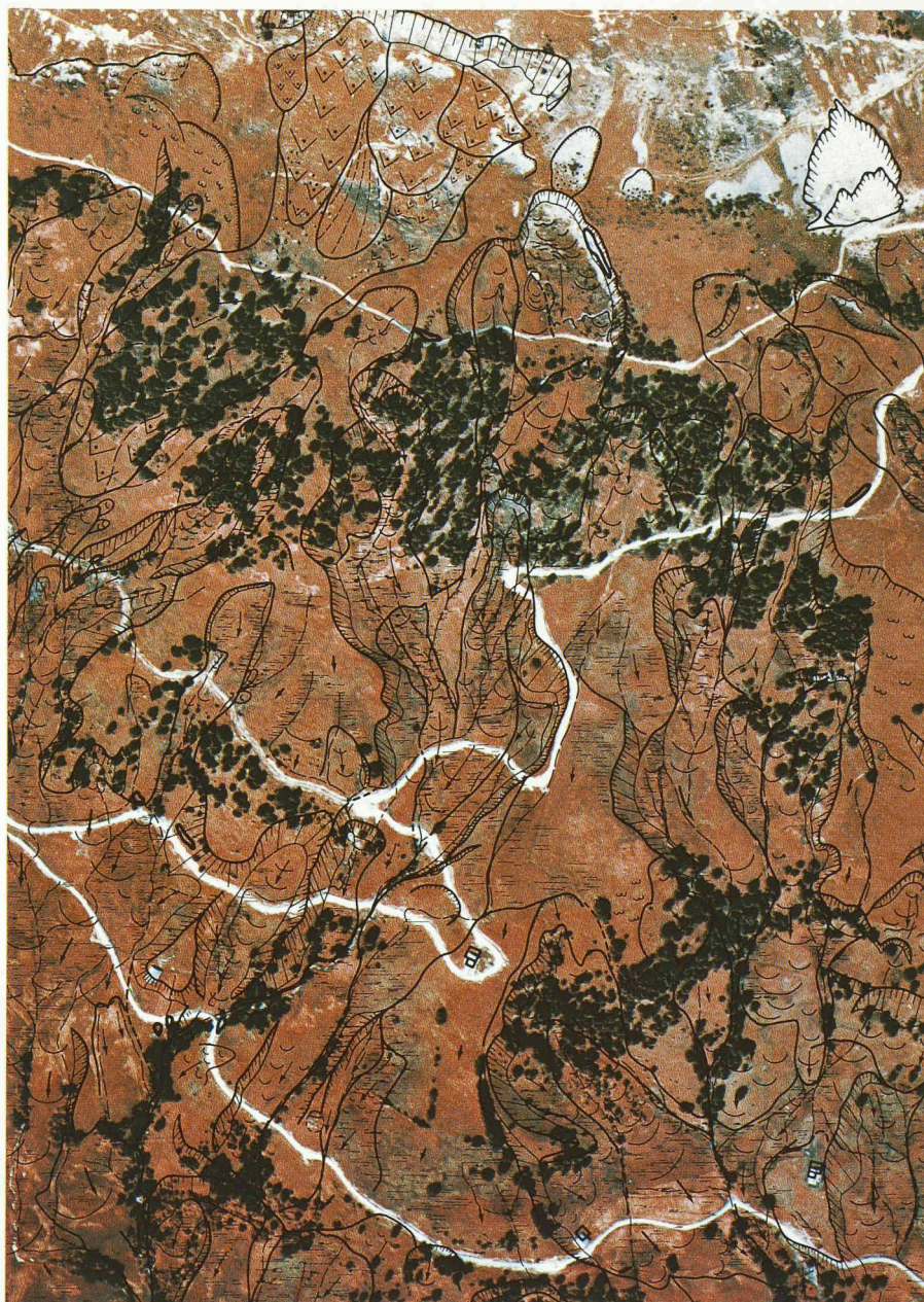
Fig. 3. — Photographie fausses couleurs infrarouge de la région du Col de la Croix avec interprétation géologique. Sont indiqués en particulier les mouvements de glissement très actifs (flèches longues), peu actifs (flèches moyennes) ou stabilisés (flèches courtes); d'autre part, on indique la niche d'arrachement et les écoulements rocheux.
