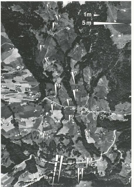
Fig. 2. — Déplacement du terrain de la région de La Frasse, déterminé à l'aide de la photogrammêtrie. Les flèches indiquent les mouvements pour les périodes 1957-1969 (gauche), 1969-1974 (centre) et 1974-1980 (droite).
