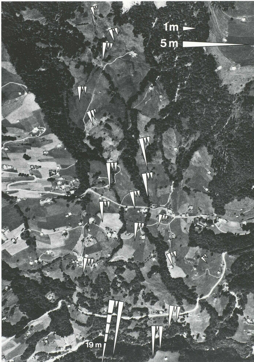
Fig. 2. — Déplacement du terrain de la région de La Frasse, déterminé à l'aide de la photogrammétrie. Les flèches indiquent les mouvements pour les périodes 1957-1969 (gauche), 1969-1974 (centre) et 1974-1980 (droite). La présentation se limite à une sélection de points; l'échelle donnée pour les flèches se réfère à une période constante de 6 ans, les mouvements mesurés pour 1956-1969 ont donc été réduits de moitié.
