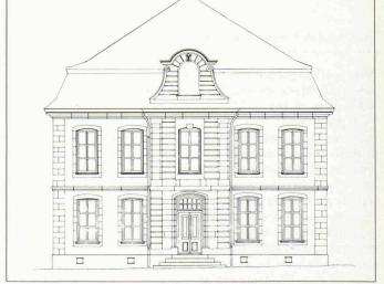
Fig. 4. — Exemple d'un levé de façade par photogrammétrie. A gauche, la photo originale prise par une chambre métrique qui a servi pour dessiner un plan de la façade (à droite).
