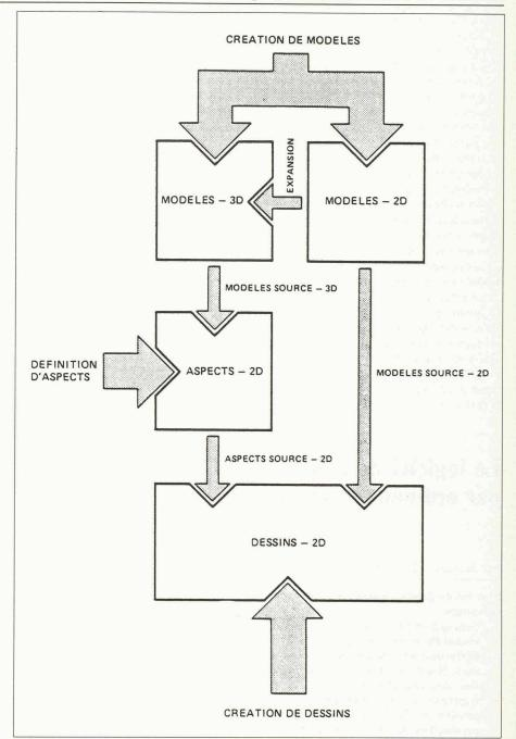
Fig. 2. - Cheminement des actions de l'utilisateur dans le processus de création de modèles, d'as-
