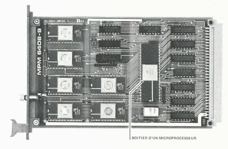
Fig. 3. — Implantation d'un microprocesseur sur une carte.
