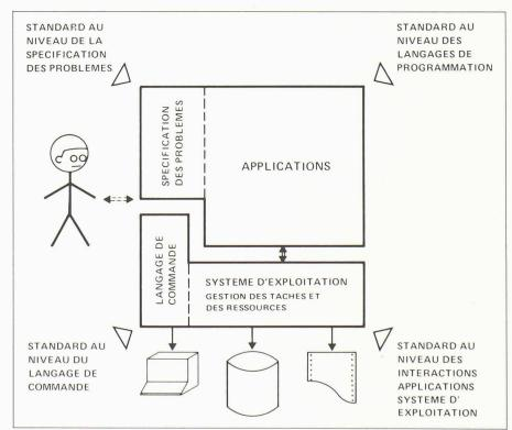
Fig. 7. — Schéma des relations utilisateur-applications-système d'exploitation.
