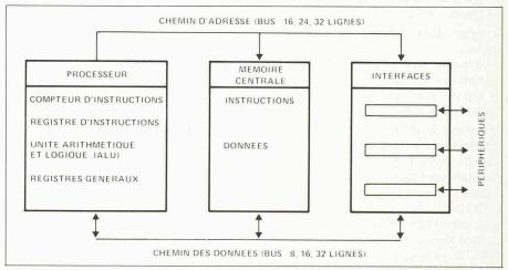
Fig. 5. - Architecture simplifiée d'un ordinateur.
