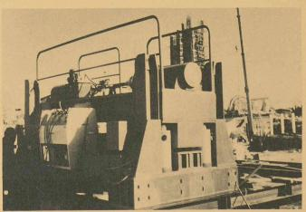
L'équipement clé pour cette opération de pivotement : la motopompe hydraulique Enerpac à quatre débits séparés, les vérins Enerpac et les deux énormes pivots.
