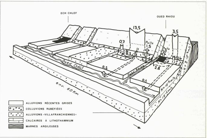
Fig. 3. – Bilan des débits souterrains (en millions de m³/an).
