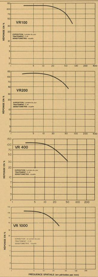
Courbe de transfert de modulation. La fonction de transfert de modulation du film représente la capacité du film à reproduire avec précision des signaux de différentes fréquences spatiales. Une réponse de 100 % signifie que le signal de sortie du film contient toutes les informations du signal d'entrée, compte tenu du seuil reproductible.
