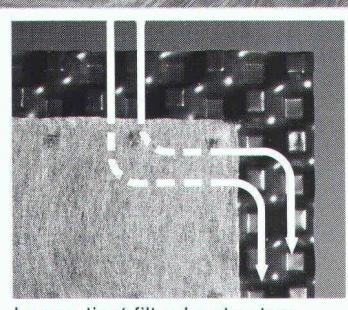
Le non-tissé filtre. La structure à excroissances, joue le rôle d'un réseau de canaux, assurant ainsi l'évacuation de l'eau dans le drain.
