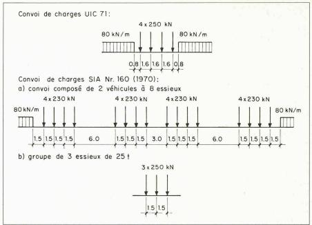
Fig. 8. - Schémas de charges UIC 71 et SIA 160 (1970).
