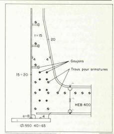
Fig. 7. — Détails de construction (joint demicadre).
