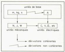
Fig. 5. — Schéma des relations entre les différentes unités.
