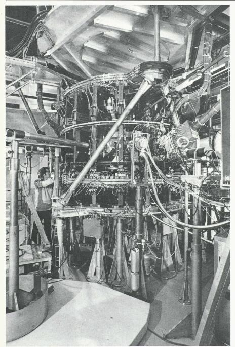
Fig. 12. — Le Tokamak TCA (Tokamak pour l'étude du chauffage du plasma par absorption d'énergie déposée par les ondes dites d'Alfvén); centre de recherches en physique des plasmas, EPFI
