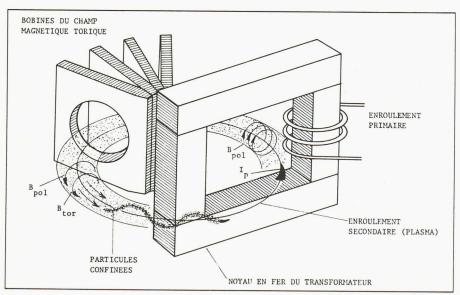
Fig. 13. — Schéma des principes du tokamak.
