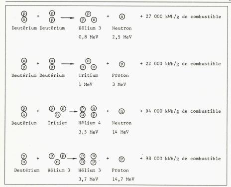
Fig. 1. — Les principales réactions de fusion.
