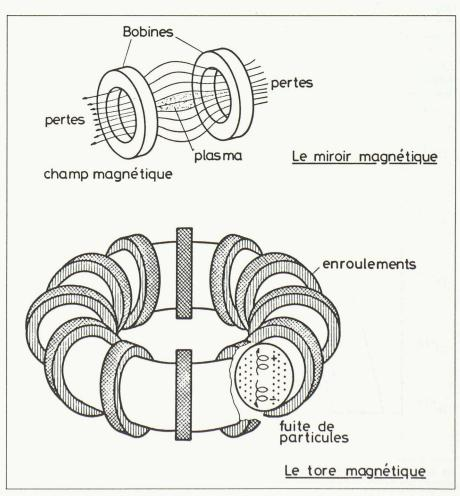
Fig. 10. — Machines à confinement magnétique.
