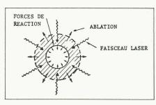
Fig. 9. — Schéma d'irradiation d'une cible par faisceau laser: compression puis explosion.
