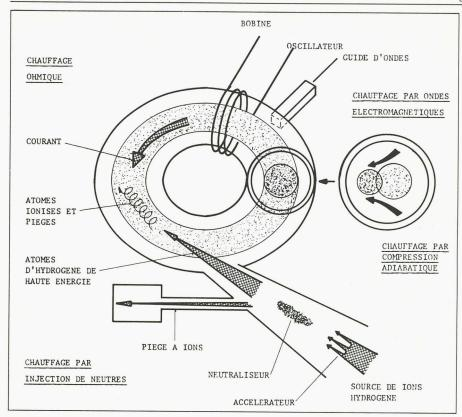
Fig. 11. — Illustration des méthodes de chauffage.
