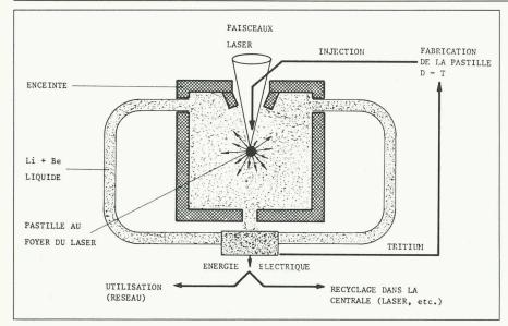
Fig. 8. — Principe de la fusion laser.
