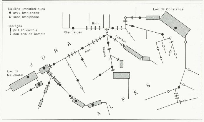
Fig. 1. — Schéma du bassin versant du Rhin à Rheinfelden. Réseau hydrographique avec les stations de jaugeage et limnimétriques utilisées.
