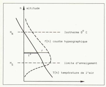
Fig. 2. — Détermination du paramètre «fonte des neiges». Représentation schématique du profil des tempéraures t (h) et de la courbe hypsographique f (h) dans le domaine de l'isotherme 0 °C et de la limite temporaire d'enneigement.
