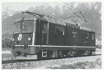
Locomotive à thyristors Bo'Bo' Ge 4/4<sup>11</sup> des Chemins de fer rhétiques. (Photo SLM)
