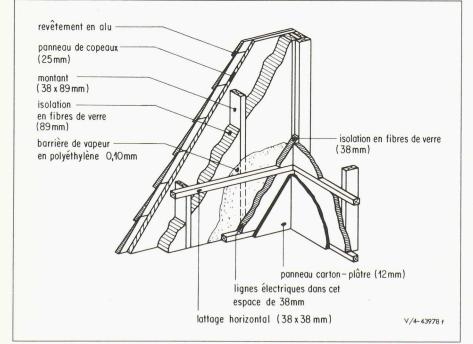
Fig. 2. — Proposition nouvelle pour paroi de construction légère; les avantages résident dans une bonne étanchèité à l'air et une bonne isolation acoustique [5].
