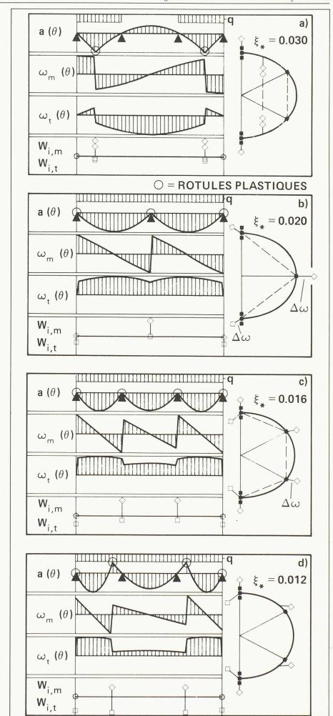
Fig. 6. — Exemples de mécanismes développés sur 2 et 3 travées.
