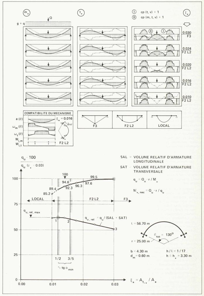
Fig. 5. — Evolution du comportement plastique d'une travée intermédiaire en fonction du taux d'armature transversale  $\xi_{\star}$ .
