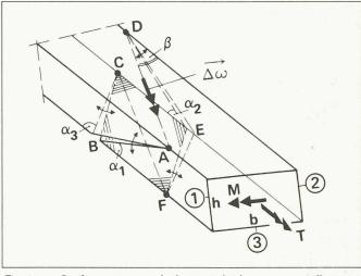
Fig. 4. — Configuration spatiale d'une rotule plastique sous sollicitation combinée.
