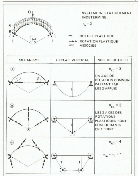
Fig. 2. Mécanismes de ruine fondamentaux de la poutre courbe bi-encastrée à ses deux extré-
