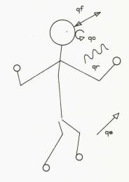
La température équivalente combinera les paramètres suivants: -température de l'air -température sèche -température des parois -vitesse de l'air
