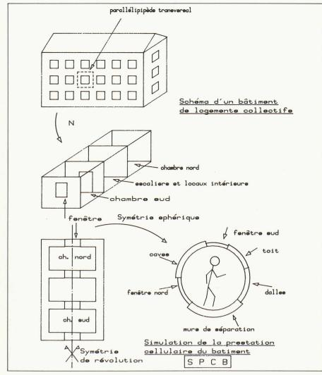
Fig. 8. — Transformation topologique d'un bâtiment-type en cellules sphériques.
