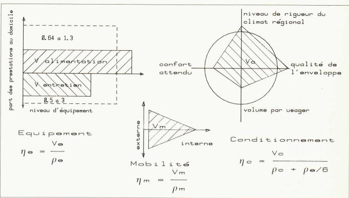
Fig. 6. — Abaque du niveau de prestation d'un bâtiment.
