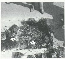
Fig. B3. — Echantillon 1: le revêtement en enrobé, d'une épaisseur totale de 11 cm, a sa couche inférieure désenrobée (a). Sur les faces de rupture, le bitume se détache du gravillon (b). L'étanchéité est recouverte de gravillon désenrobé et d'eau stagnante provenant du revêtement (c).
