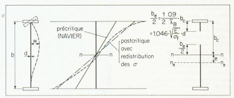
Fig. 4. — Comportement postcritique de l'âme mince d'une poutre fléchie; modèle pour le calcul de la section réduite d'une poutre symétrique.
