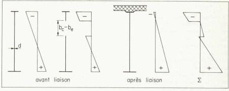
Fig. 6. — Modèle a) pour l'étude d'une poutre mixte à âme mince en travée.
