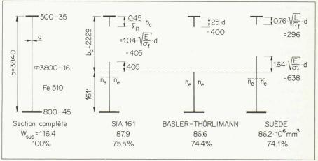
Fig. 5. — Poutre fléchie dissymétrique à âme mince; comparaison de trois modèles de calcul dans le domaine postcritique.
