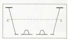
Fig. 12. — Section «complète» servant de base au calcul de la section réduite des âmes d'une poutre-caisson.
