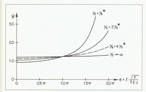
Fig. 11. — Coefficient  $\psi$  en fonction des paramètres  $\varepsilon$  et  $\gamma_s$ .
