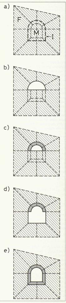
Fig. 1. — Etapes de construction d'un tunnel: a) milieu initial, b) excavation de la voûte, c) revêtement de la voûte, d) excavation de la base, e) revêtement).
