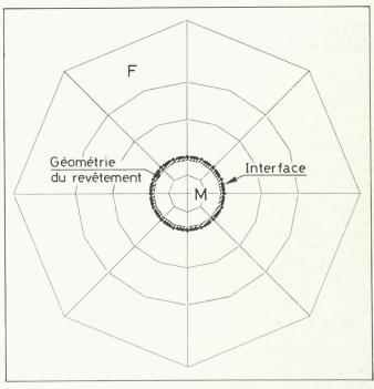
Fig. 6. — Détail de la zone à excaver (F: partie fixe, M: partie mobile).
