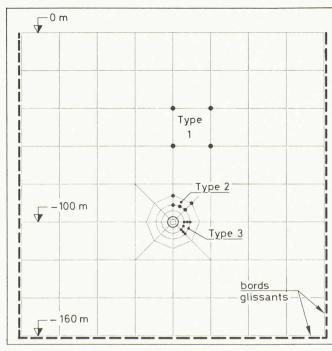
Fig. 5. — Réseau d'éléments finis.
