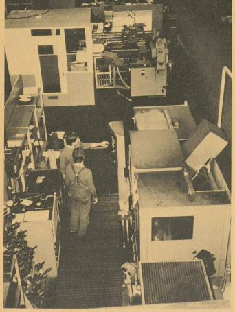
« Ilot de fabrication autonome » équipé de machines d'usinage. Au fond, à gauche, la cabine de commande connectée à l'ordinateur pour la programmation et l'ordonnancement des ordres.
